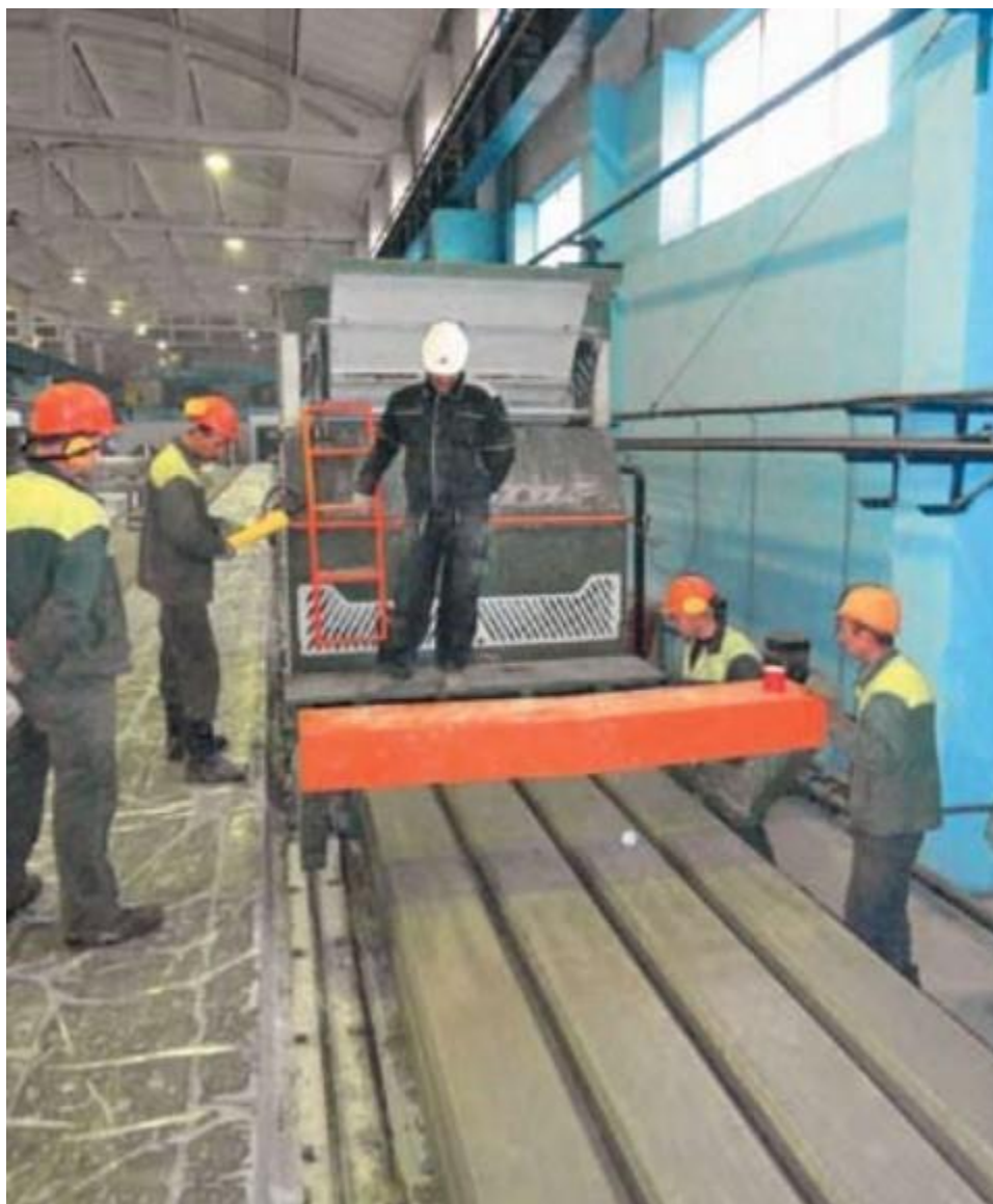
Бір амалмен Вибрациялы қалыптау әдісімен қадалар әзірлеу
