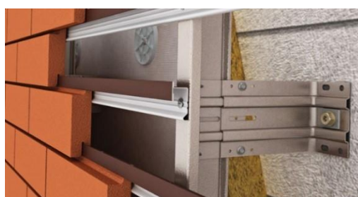
Рисунок 5. Утепление вентилируемым фасадом
